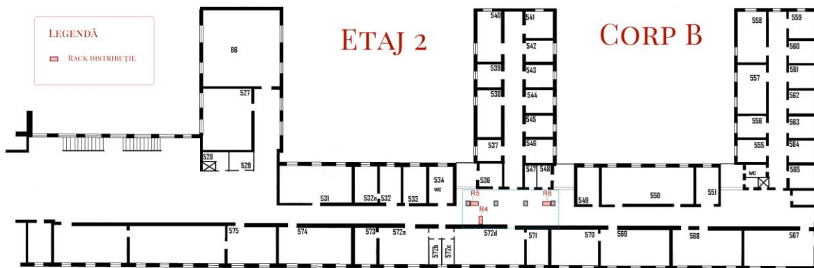
Figura 2. Propunere locație instalare punct de distribuție Etaj 2.
